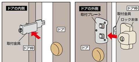
取付金具をドア枠に固定します。
